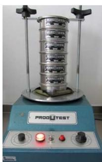
Figura 13 - Tamisador automático utilizado na determinação da faixa granulométrica
