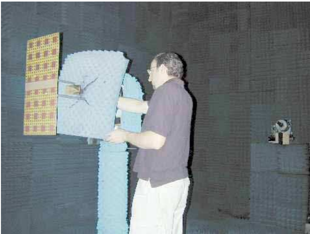
Fig. 1.4. Fotografia de uma câmara anecóica utilizada em medições de FSS (GIANVITTORIO, 2003).
