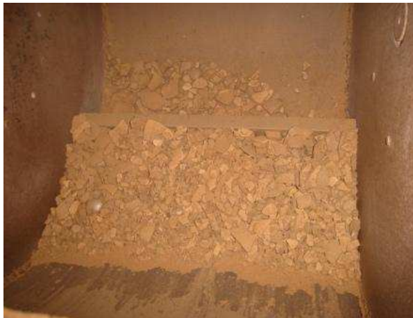
Figura 16: Segunda etapa de quebra do endocarpo, com uso da máquina "Los Angeles"
