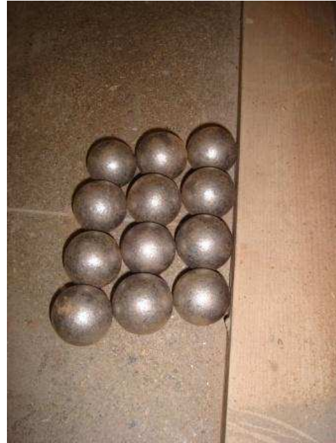
Figura 15: Carga abrasiva (12 esferas de ferro fundido)
