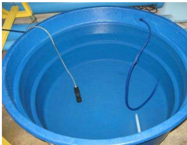
Figura 26: Reservatório com capacidade para 250 litros – entrada de água para as câmaras C1 e C2 (Ponto de Coleta – E)
