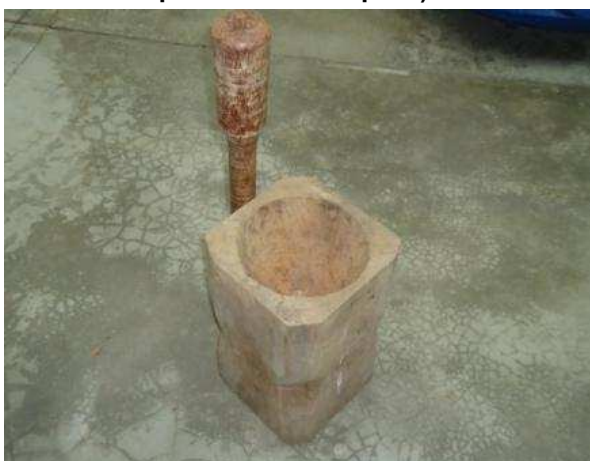
Figura 13: Primeira etapa de quebra do endocarpo, com o pilão de madeira
