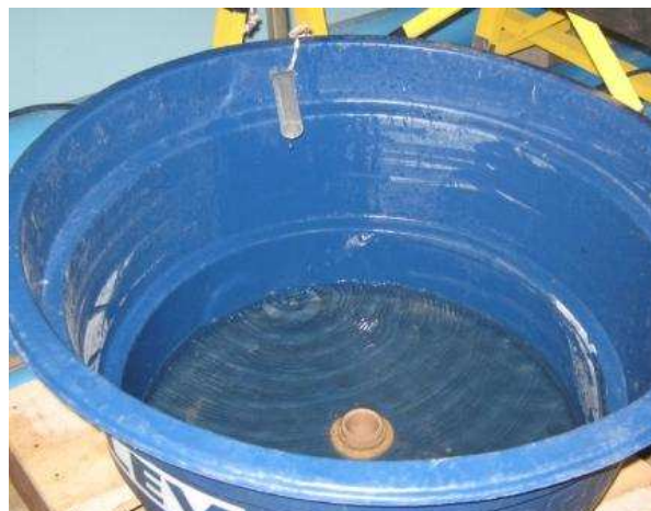
Figura 27: Reservatório com capacidade para 150 litros - saída de água das câmaras C1 e C2 (Pontos de Coleta – S1 e S2)
