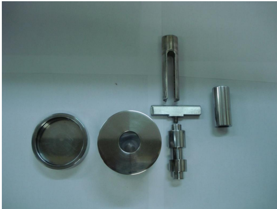
Figura 3.3.3 - Matriz de aço ferramenta utilizada na conformação dos toróides.
