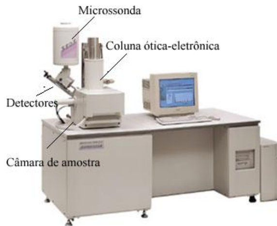
Figura 3.4.5.1 - Microscópio eletrônico de varredura (MEV), modelo SSX-550 da Shimadzu com espectrômetro por energia dispersiva (microanálise) acoplado.
