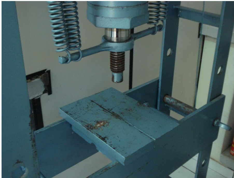
Figura 3.3.2 - Prensa hidráulica utilizada para a compactação dos toróides
