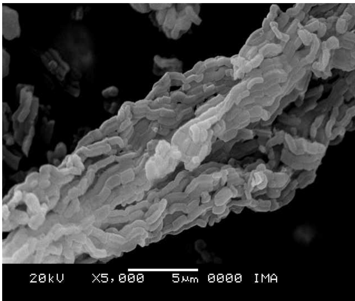
Figura 32: MEV da amostra AISBA-15 com Si/Al = 50 obtida com ampliação de 5000x
