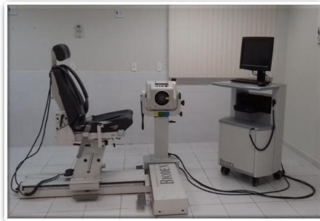
Figura 2. Sistema de dinamometria isocinética utilizada para avaliação do desempenho muscular em CCA.
