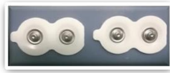
Figura 4. Eletrodos de superfície autoadesivos, passivos e simples diferenciais utilizados para a aquisição do sinal.
