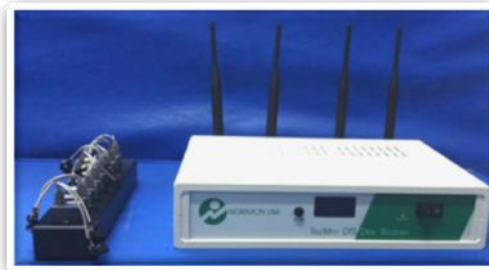
Figura 3. Módulo condicionador de sinais utilizado para a captação da atividade elétrica dos músculos VMO e VL.
