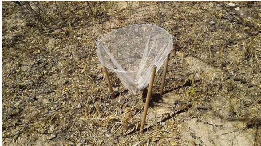
Figura Suplemenar 1 – Coletor utilizado no experimento para a estimativa da taxa de queda das folhas.
