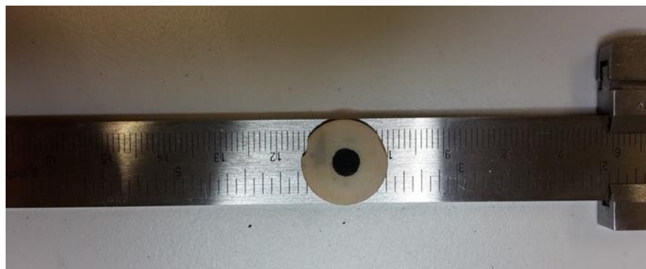
Figura 3.2 Célula simétrica obtida após serigrafia e sinterização a 1300 °C por 4 h.
