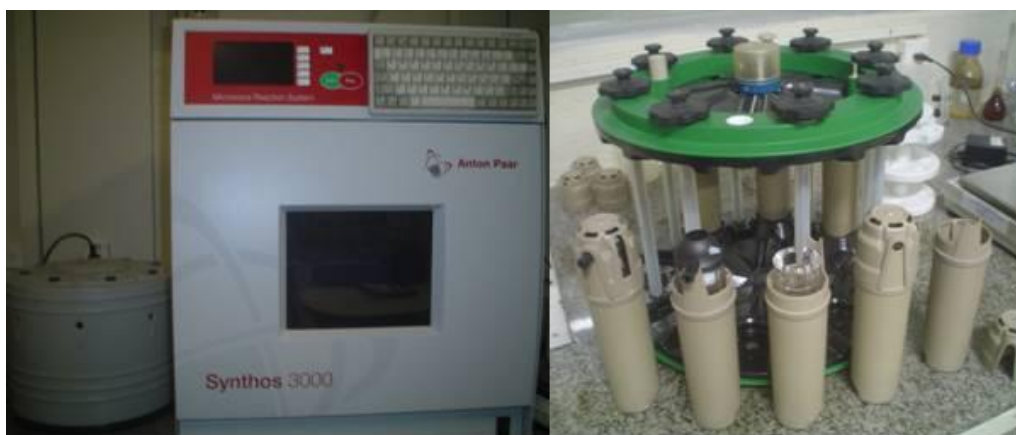
Figura 3.6 – Foto do reator de micro-ondas Synthos 3000 Anton Paar; foto da base giratória e tubos de quartzo. Fonte: Silva (2010)
