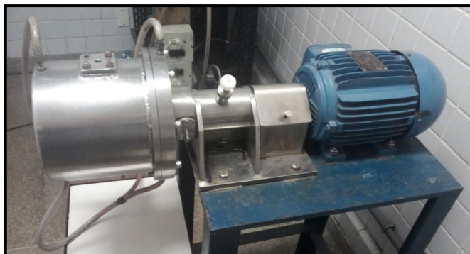
Figura 12. Moinho atritor horizontal do Laboratório de Moagem de Alta Energia do IFBA.
