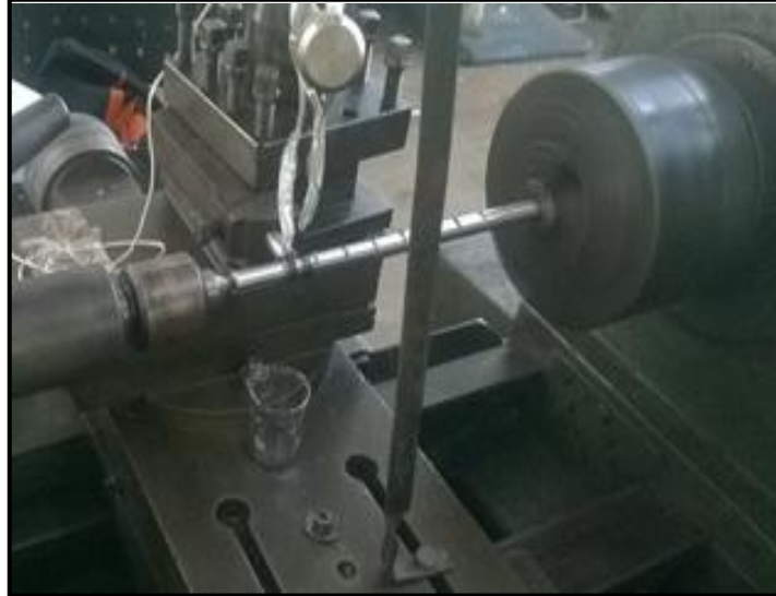
Figura 29. Foto do torno no momento do ensaio tribológico.
