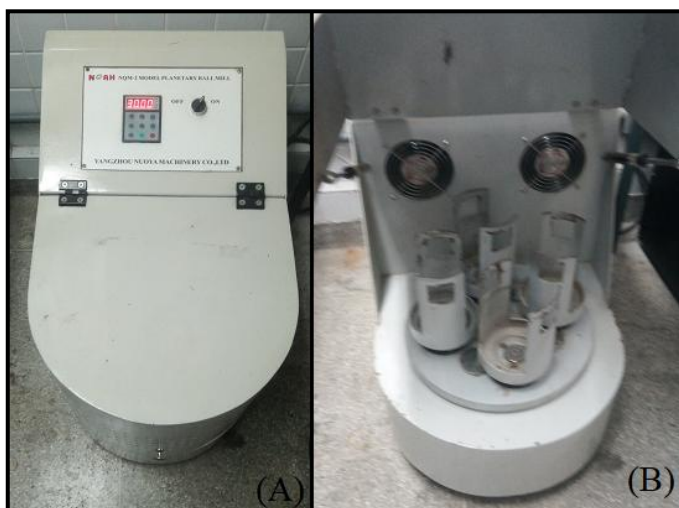
Figura 13. Moinho Planetário do Laboratório de Moagem de Alta Energia do IFBA. (A) Fechado (B) Aberto mostrando o Carrossel
