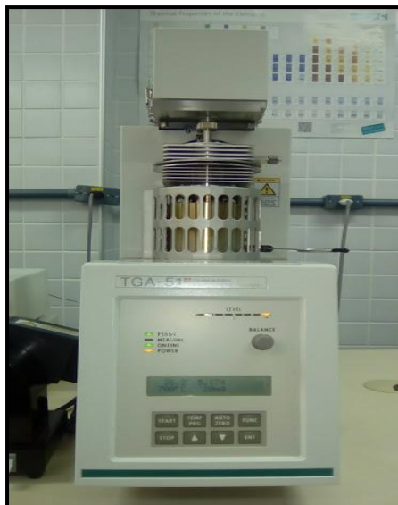
Figura 16. Equipamento de análise termogravimétrica.
