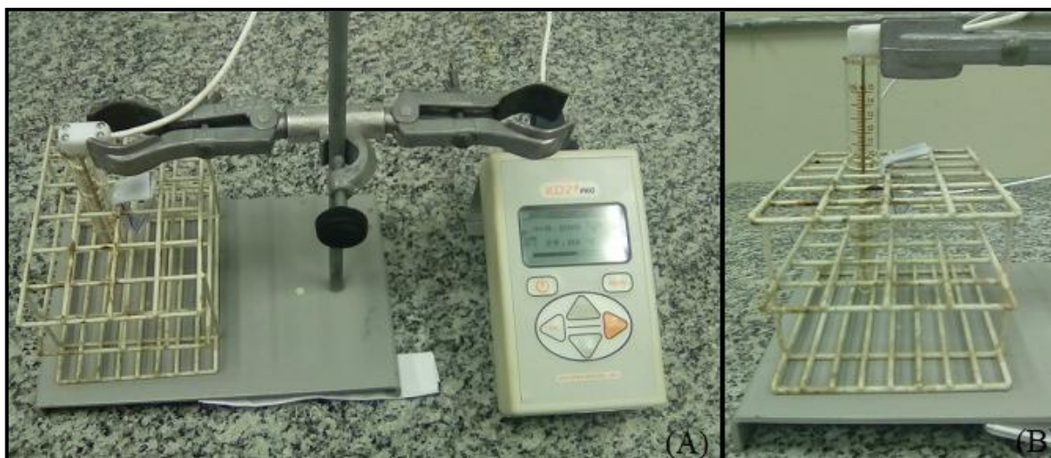
Figura 24. Foto do ensaio de Condutividade e Resistividade (A) Óleo in-natura (B) Óleo Transesterificado
