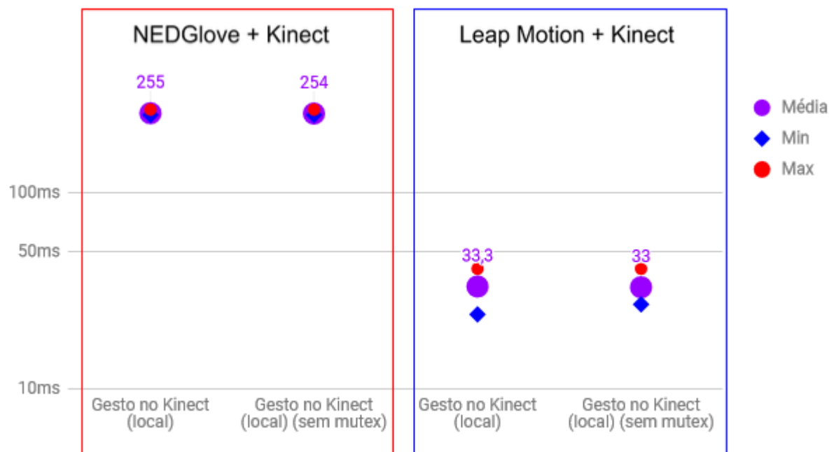
Figura 42 – Teste de carga da união dos dispositivos com e sem mutex
