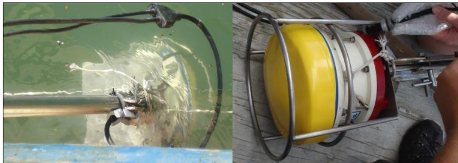
Figura 16: ADCP modelo Rio Grande da RDI utilizado neste estudo. A) sensor na água; B) sensor a bordo.
