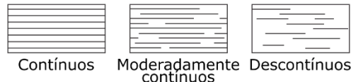
Figura 22 – Ilustração esquemática das terminação de refletores, radarfácies e configuração dos refletores em radargrama
