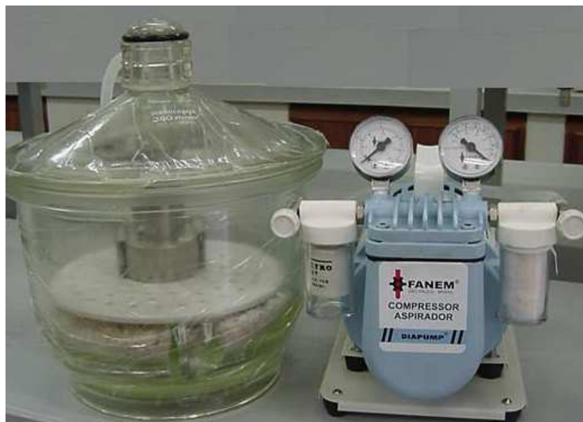
Figura 3.3- Representação do conjunto para realização do ensaio de permeabilidade.
