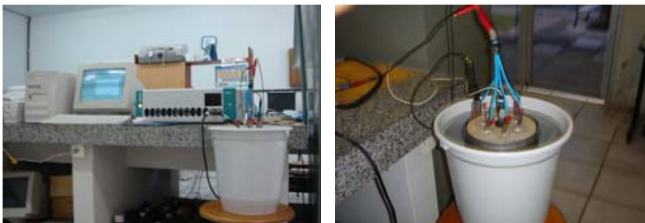
Figura 3.6- Equipamento de medida e cela eletroquímica montada para os ensaios de impedância espectroscópica e curvas de polarização.
