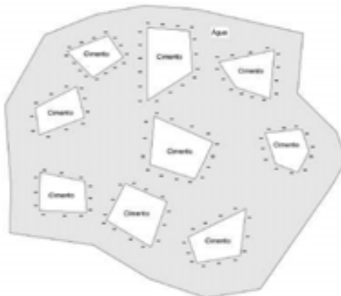
Figura 10 - Defloculação das partículas de cimento pela ação das moléculas do aditivo.
