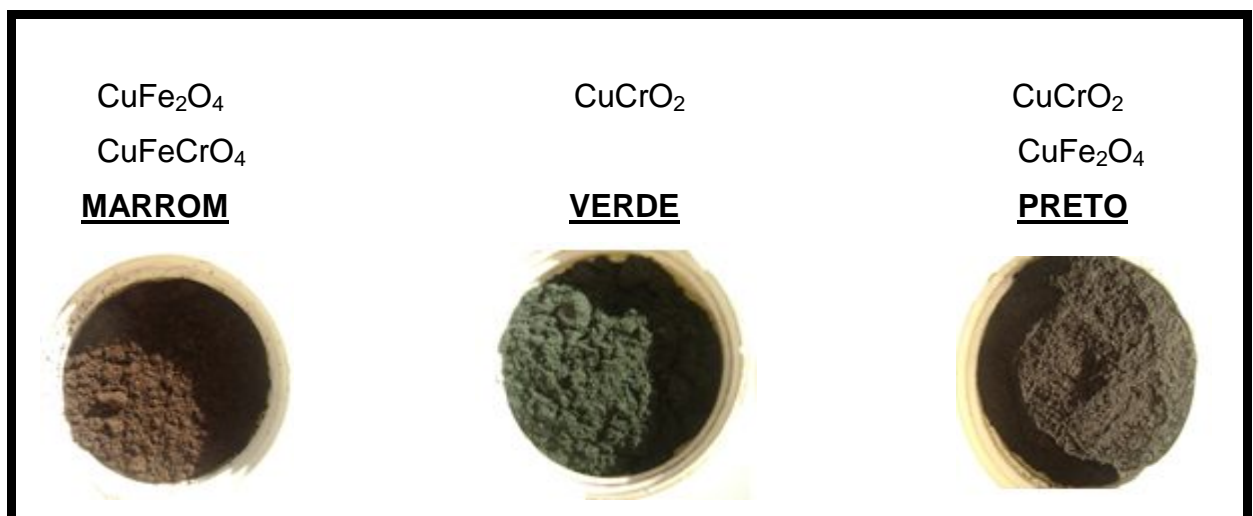
Figura 26: Cores dos pigmentos obtidos pelos compostos CuFe 2 O 4 , CuCrO 2 , CuFeCrO 4 , respectivamente.
