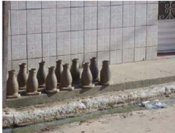
Figura 70: Pequenas peças endurecendo ao sol na calçada Fonte: Arquivo pessoal, 2009
