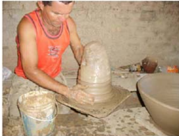
Figura 45: Artesão apoiando bolo de barro sobre o prato Fonte: Arquivo pessoal, 2009
