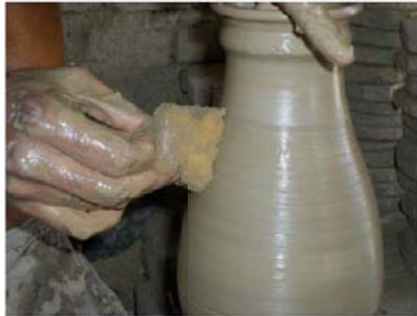
Figura 58: Esponja sendo aplicada para retirada do excesso de água Fonte: Arquivo pessoal, 2009
