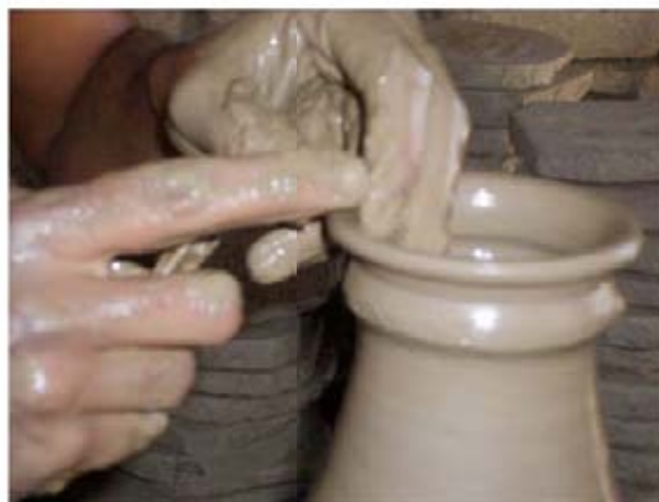
Figura 57: Artesão dando acabamento com a mão na boca da peça Fonte: Arquivo pessoal, 2009
