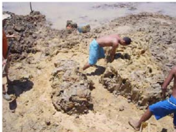
Figura 34: Separação do barro em bolos para verificação e eliminação de impurezas Fonte: Arquivo pessoal, 2009
