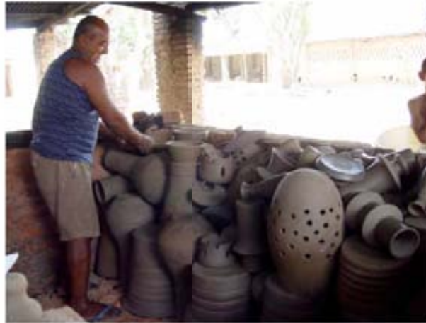
Figura 80: Artesão arrumando as peças no forno Fonte: Redi, 2008
