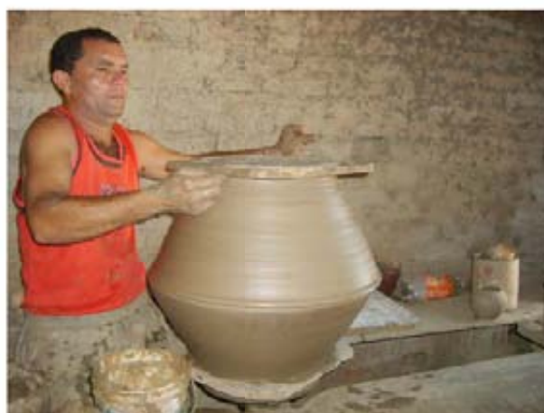
Figura 68: Capilé utilizando o nylon para separar a parte superior da peça Fonte: Arquivo pessoal, 2009
