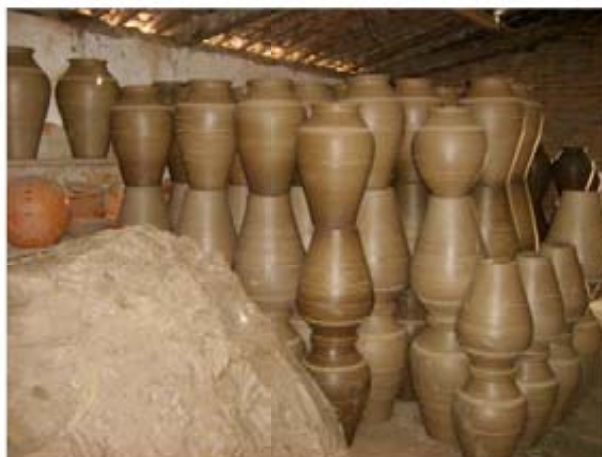
Figura 72: Peças endurecendo à sombra sobre o chão Fonte: Arquivo pessoal, 2009
