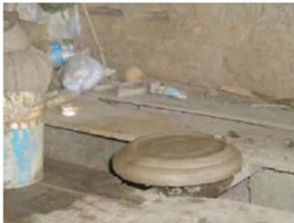
Figura 46: Camada de argila sobre o disco menor do peão para criar liga Fonte: Arquivo pessoal, 2009
