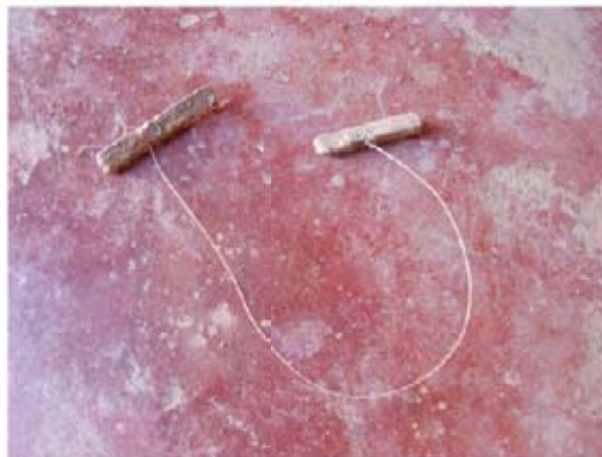
Figura 67: O nylon, ferramenta utilizada para separar a peça do prato Fonte: Arquivo pessoal, 2009
