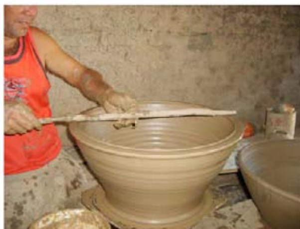
Figura 60: Capilé utilizando a vareta para medir o diâmetro de uma peça Fonte: Arquivo pessoal, 2009
