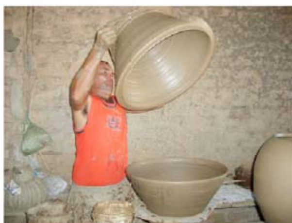
Figura 61: Capilé juntando as duas metades para finalizar a peça Fonte: Arquivo pessoal, 2009
