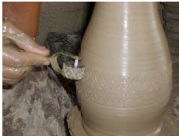
Figura 59: Aplicação de textura com a utilização do carretel Fonte: Arquivo pessoal, 2009
