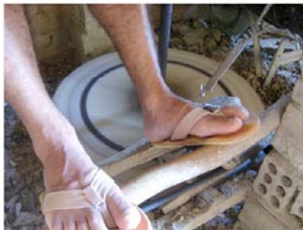
Figura 49: Alavanca acionada com os pés para movimentar o peão Fonte: Arquivo pessoal, 2009
