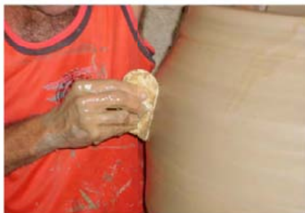
Figura 54: Artesão utilizando a cana durante a modelagem Fonte: Arquivo pessoal, 2009
