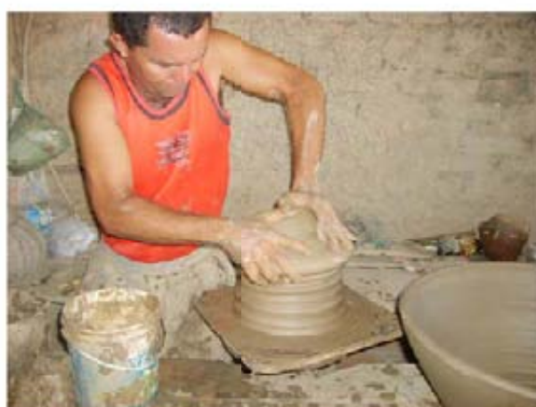
Figura 42: Posição de trabalho do artesão no torno Fonte: Arquivo pessoal, 2009
