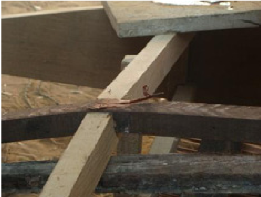
Figura 47: Momento em que a espinha se partiu. Fonte: Acervo do Projeto Jangadeiros (GREPE/UFRN)
