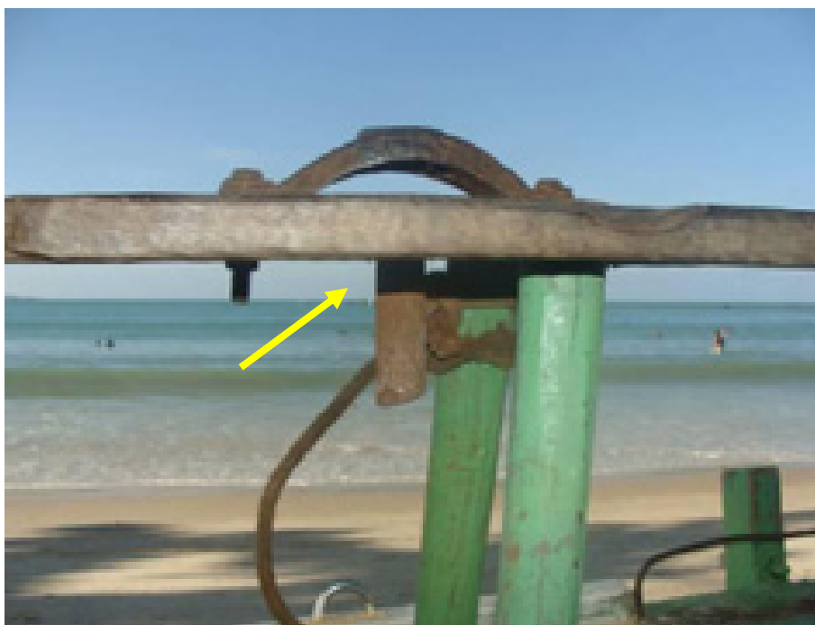
Figura 29: Peça de metal - adequação sobre o banco de governo para apoiar o motor. Fonte: Acervo do Projeto Jangadeiros (GREPE/UFRN)
