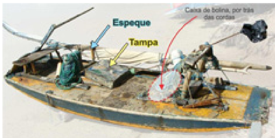
Figura 25: Jangada com layout desfavorável à pescaria utilizando redes.
