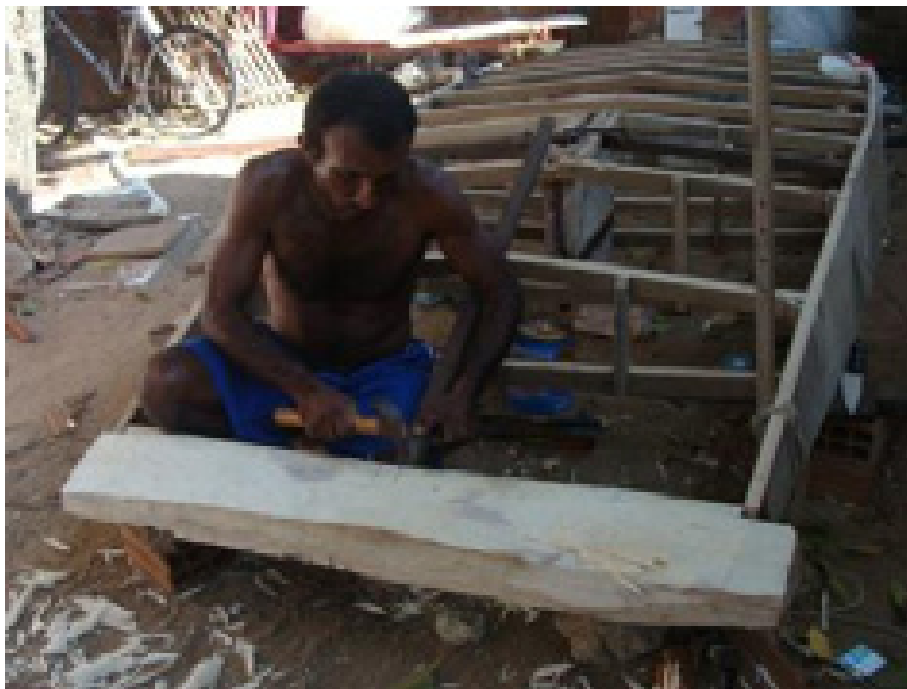
Figura 46: Carpinteiro fixando a espinha à peça de proa. Fonte: Acervo do Projeto Jangadeiros (GREPE/UFRN)
