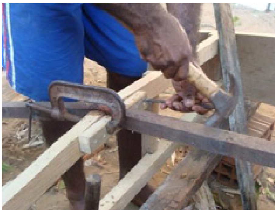
Figura 50: Carpinteiro inserindo peça de reforço à espinha. Fonte: Acervo do Projeto Jangadeiros (GREPE/UFRN)
