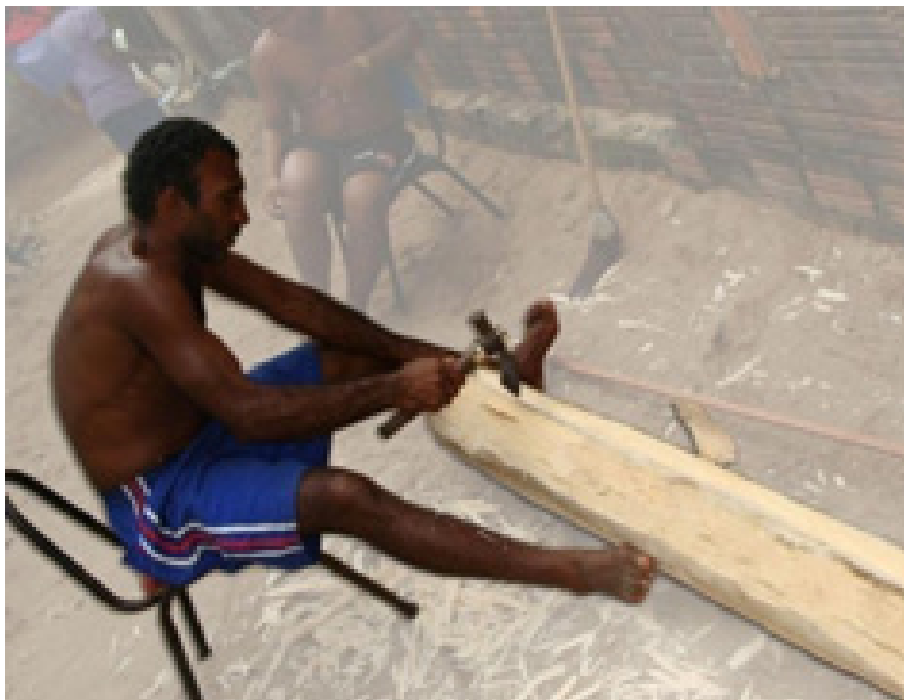
Figura 44: Peças de proa e popa sendo feitas a partir de tronco de madeira (destacado na imagem)
