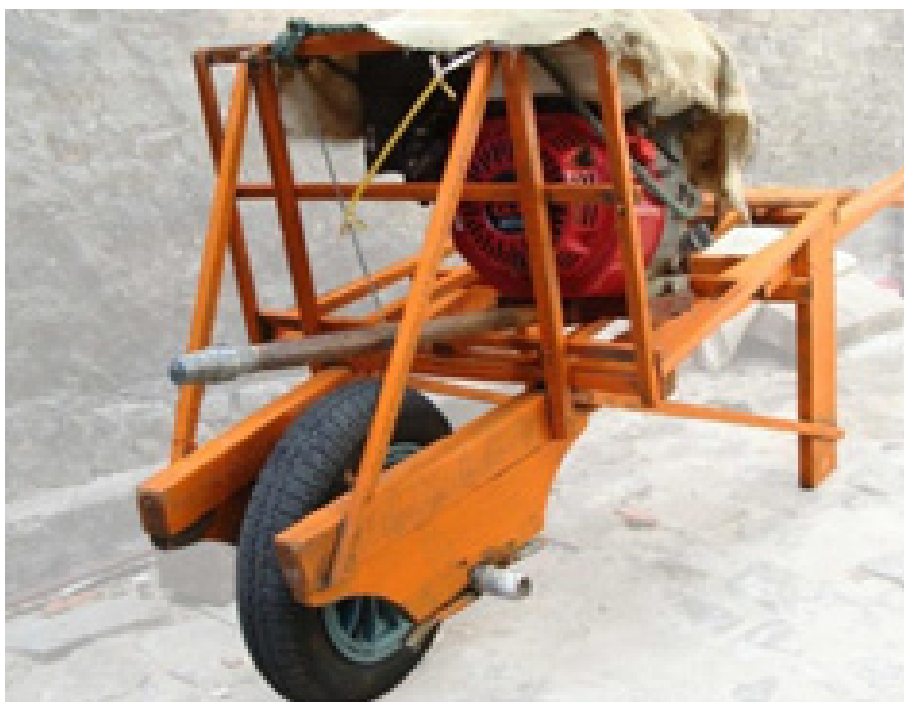
Figura 52: Carrinho artesanal em madeira para transporte de equipamentos. Fonte: Acervo do Projeto Jangadeiros (GREPE/UFRN)
