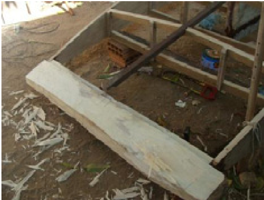
Figura 45: Espinha apoiada sobre a jangada, ainda sem ser fixada. Fonte: Acervo do Projeto Jangadeiros (GREPE/UFRN)
