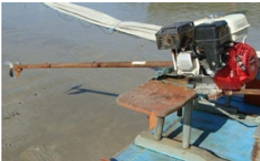
Figura 28: Eixo do motor (rabeta). Fonte: Acervo do Projeto Jangadeiros (GREPE/UFRN)
