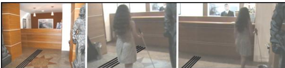
Figura 11 - Recomendação de linhas táteis direcionais na cor preta, contrastando com o piso.
