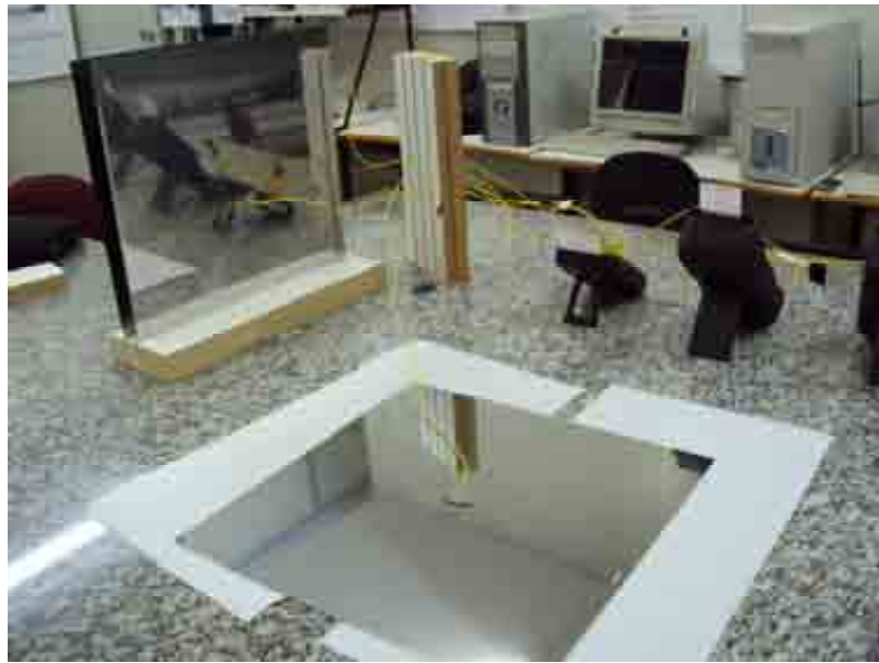
Figura 3.2. Fixação dos termopares nas chapas de aço inox 430
