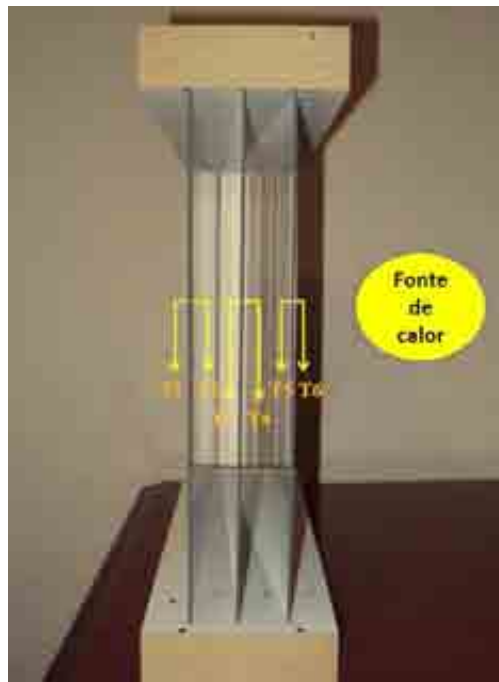
Figura 4.3. Posição dos termopares nas superfícies da chapa de aço inox.
