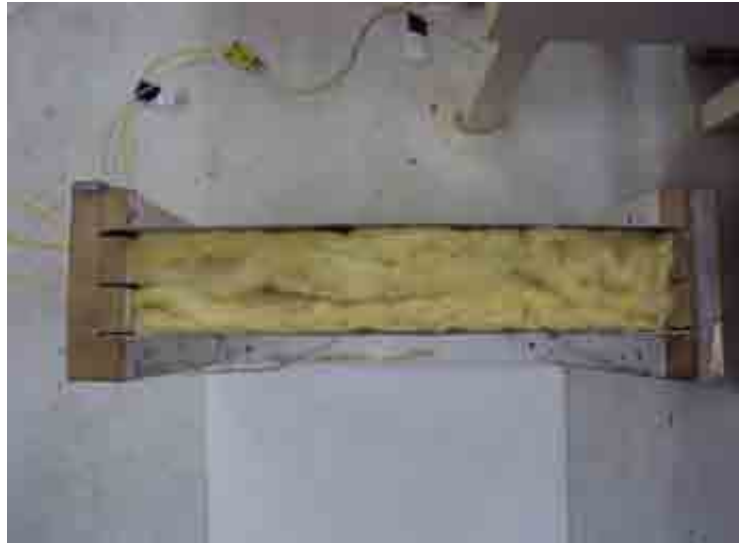
Figura 3.10. Manta de Lã de vidro introduzida entre as chapas.
