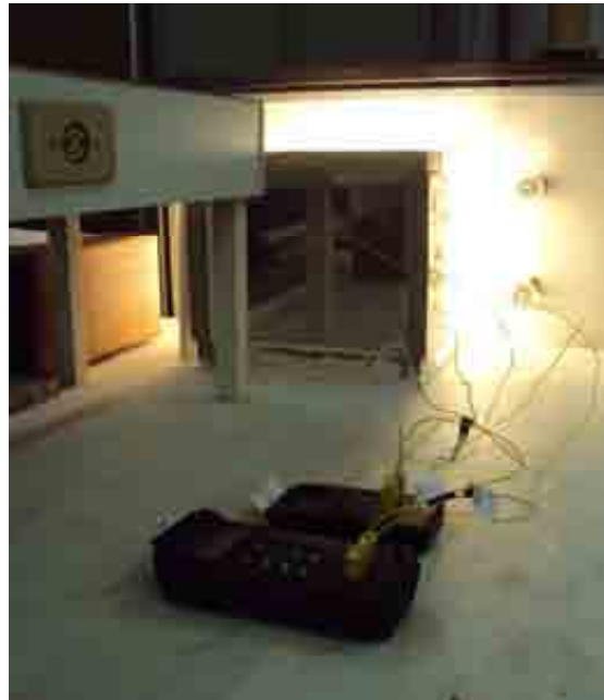
Figura 3.11. Ensaio da medição de temperatura com a presença de lã de vidro.
