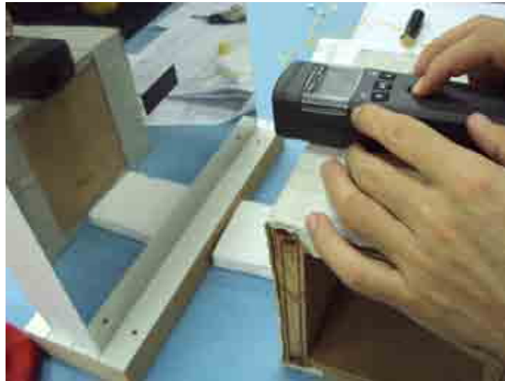
Figura 3.16. Medição de emissividade da superfície.
