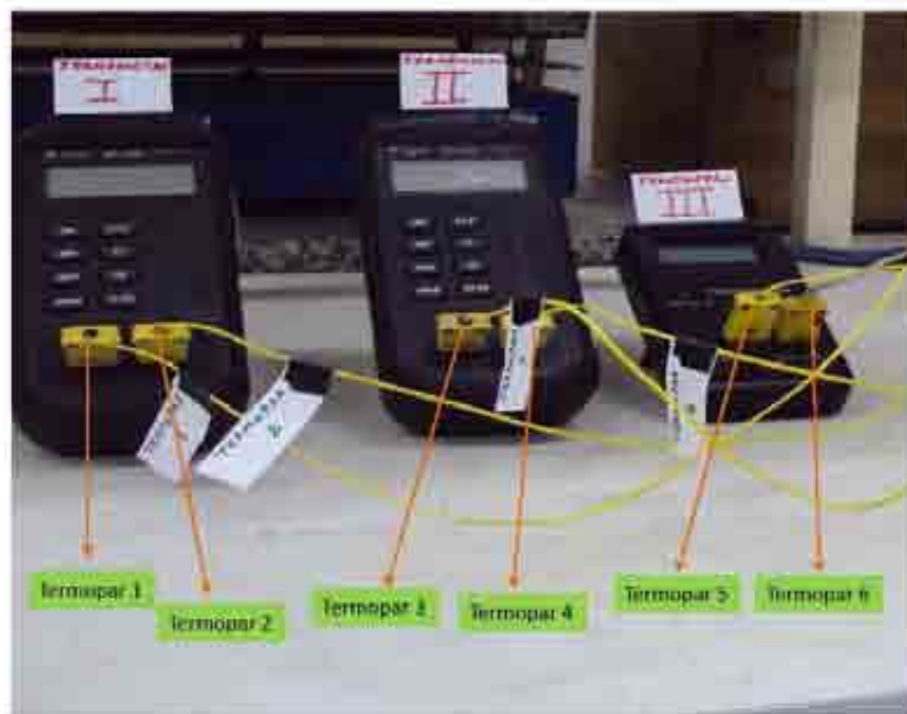
Figura 3.5. Termopares conectados aos termômetros digitais
