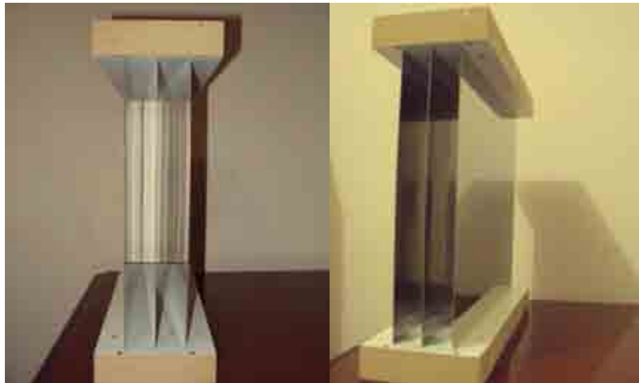
Figura 3.1. Chapas de aço inox 430 reflexivo montadas em bases de madeira.
