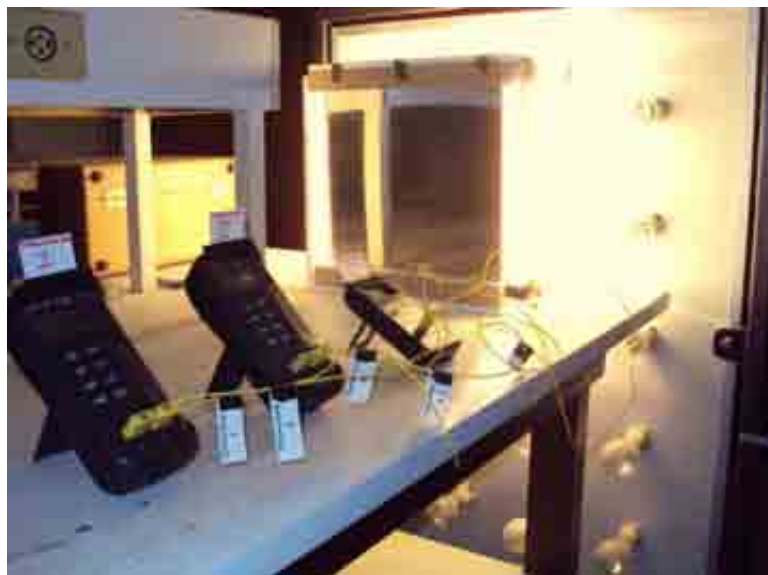
Figura 3.7. Ensaio da medição de temperatura do sistema com presença de ar.
