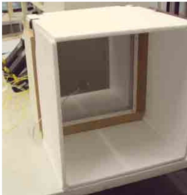
Figura 3.4. Placas de EPS fixadas no sistema para concentração de calor da fonte geradora
