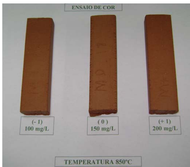
Figura 4.9. Corpos cerâmicos queimados a 850 °C.
