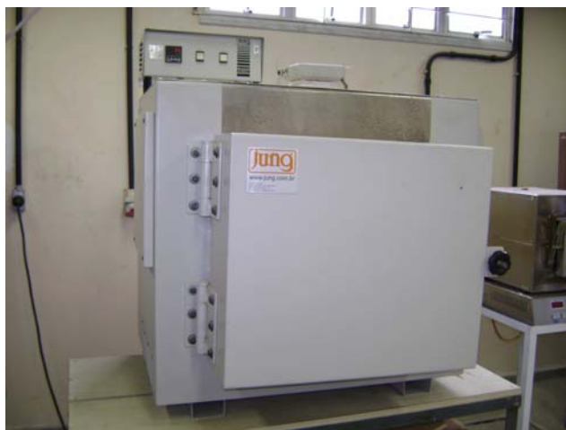
Figura 4.8 . Forno elétrico de resistência Jung ®, N° 4225, modelo 2314, ano 2004.
