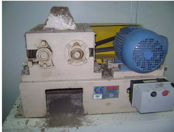
Figura 4.3. Laminador Verdés modelo 080, série 014.
