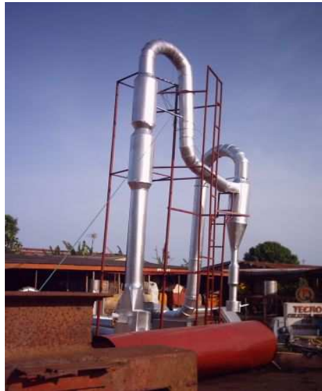
Figura 6 – Secador pneumático tipo flash com reciclo do gás
