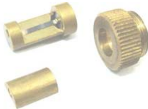
Fig. 5-14: Cavidade de microondas tipo strip line.
