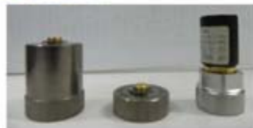
Fig. 5-15: Analisador e o kit de impedância utilizado neste trabalho para as medidas de MI, em detalhe no canto direito inferior, as cargas utilizadas na calibração do equipamento.
