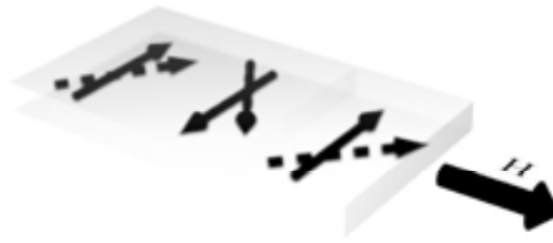
Fig. 2-4: Ilustração da estrutura de domínios mostrando a direção do campo aplicado durante a deposição, as setas cheias indicam a direção do momento magnético no momento da deposição e as setas pontilhadas indicam o momento magnético reordenado devido ao campo magnético aplicado durante a deposição.
