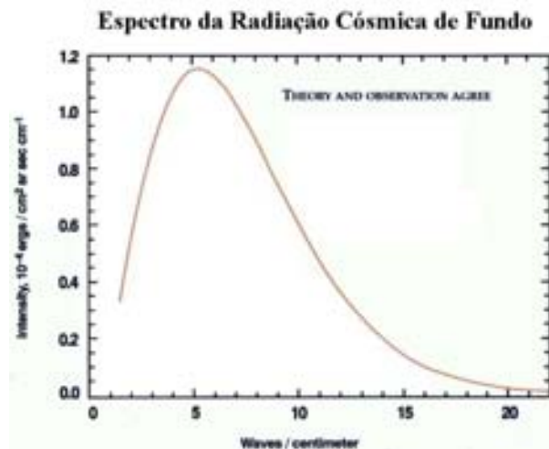
Figura 3.1: Espectro de corpo-negro da radiação cósmica de fundo. Dados experimentais medidos pelo FIRAS e curva teórica para T_0 = 2,726 K.
