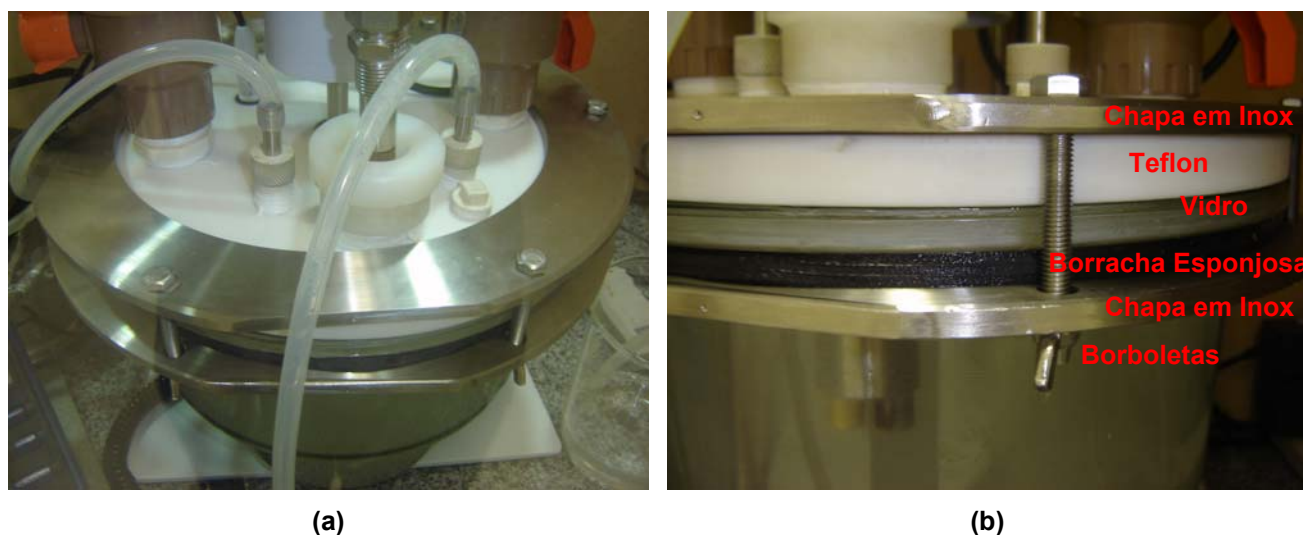
Figura 3.4 – (a) Sistema de vedação/travamento da tampa e (b) Detalhe do sistema de vedação (TÁVORA, 2007).
