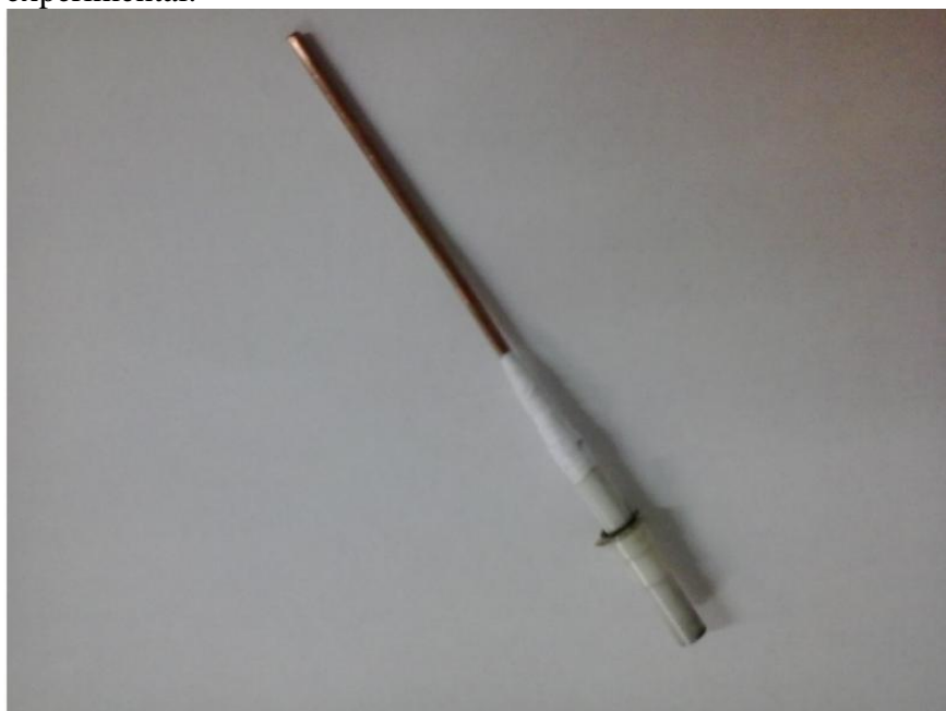
Figura 10 – Imagem do eletrodo de pasta de grafite (EPG) utilizado durante o procedimento experimental.
