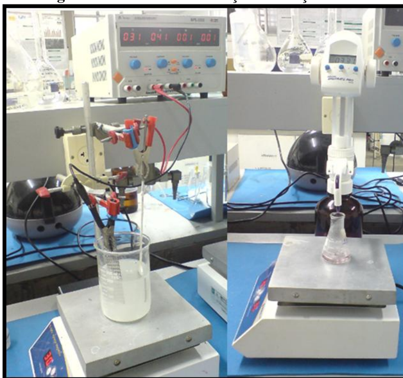
Figura 40 - Sistema de oxidação e titulação do AO.
