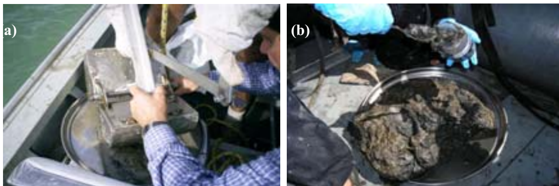
Figura 2.2 – Demonstração da amostragem realizada. (a) imagem da draga do tipo van Veen coletando o sedimento do estuário; (b) acondicionamento do sedimento em bandeja de aço inox;
