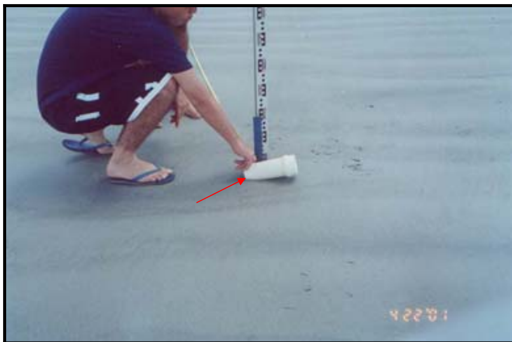
FIGURA 2.8 – Procedimento de coleta de sedimentos (Silveira/abril/2001).
