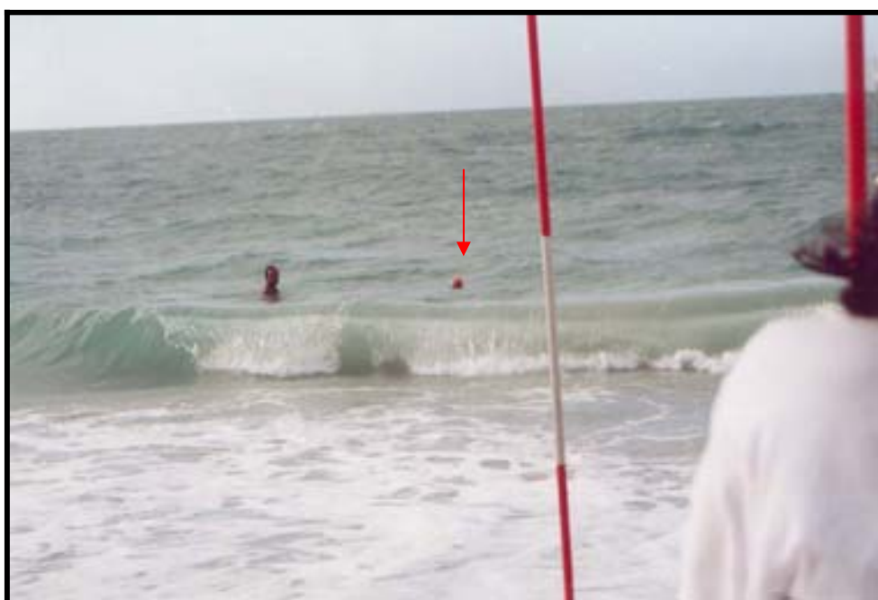
FIGURA 2.7 – Visualização do flutuante onde se determina a velocidade da corrente. (Silveira/abril/2001).
