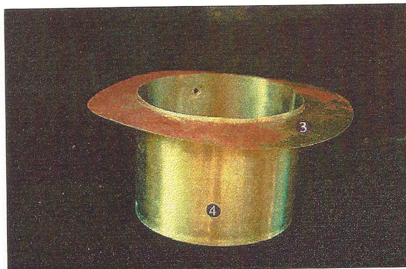
Figura 17. Vista de cima do recipiente interno e o anel de fechamento de aço carbono.
