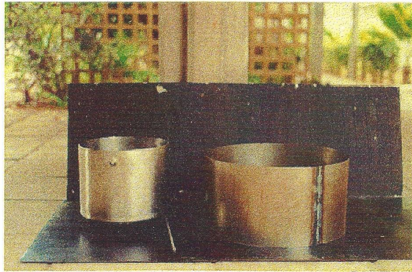
Figura 15. Vista frontal dos recipientes interno de aço inoxidável e o externo.
