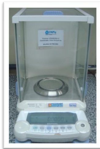
Figura 3.13. Balança analítica Shimadzu, modelo: AUY220.
