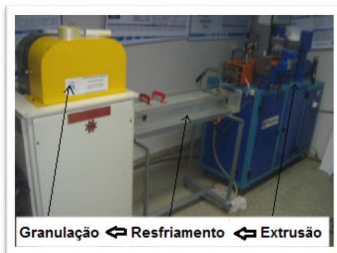
Figura 3.10. Etapas de fabricação dos grãos.
