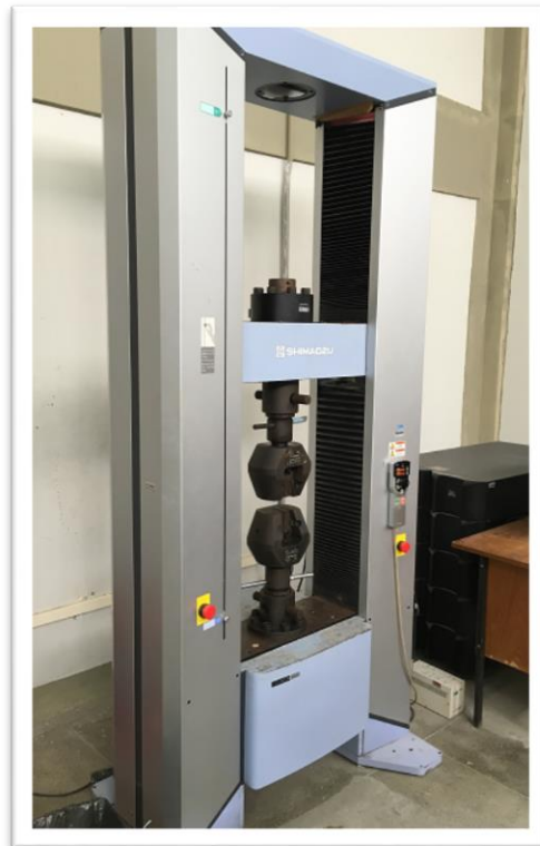
Figura 3.15. Máquina SHIMADZU, modelo: AG-X, 300KN.
