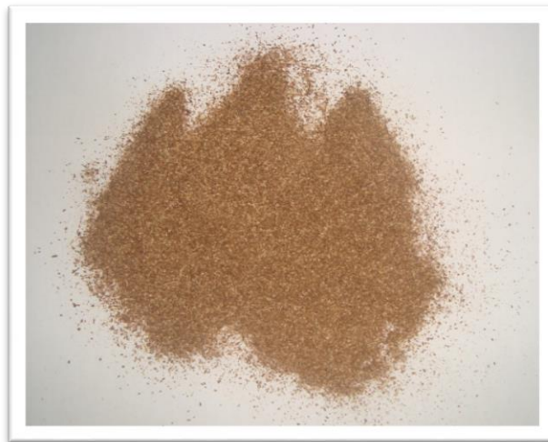
Figura 3.6. Particulado do endocarpo seco do coco com faixa granulométrica entre 35 e 65 mesh.
