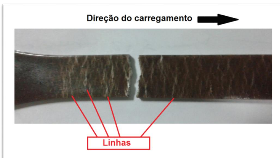
Figura 4.10. Linhas presentes no corpo de prova fraturado de polipropileno com particulado do endocarpo do coco (PP 90/10).
