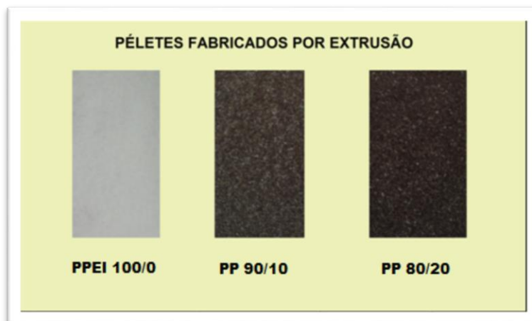
Figura 3.11. Grãos fabricados pelo processo de extrusão.
