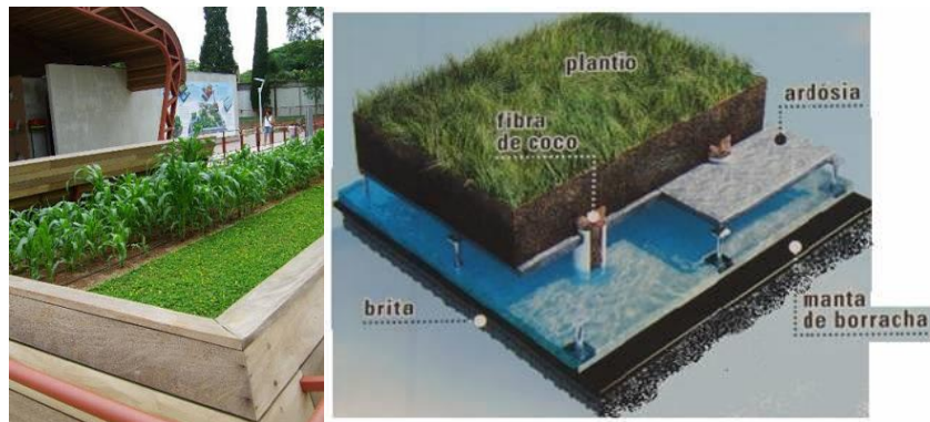
Figura 32: Mosaico e imagens – Foto e esquema do sistema de Tec garden
