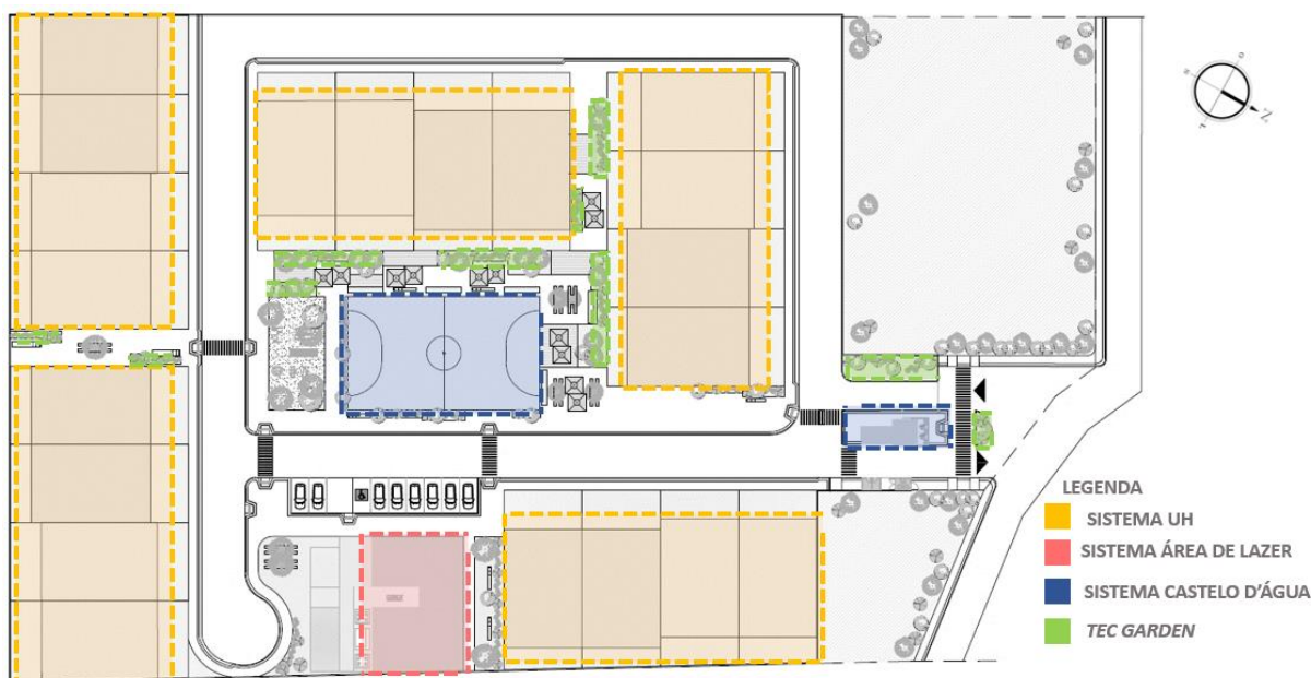
Figura 95: Esquema dos sistemas de captação de água de chuva
