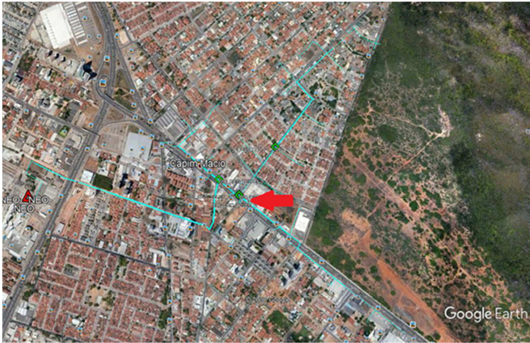
Figura 25 – Tracejado do ALIM 1 em azul juntamente com o posicionamento dos novos telecomandados sugeridos destacados pelo símbolo triângulo verde. (Fonte: Google Earth, 2017).
