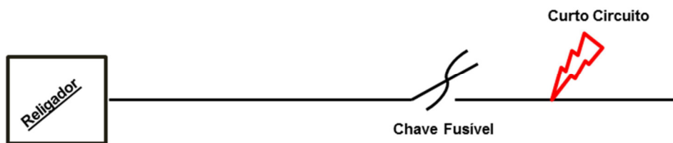
Figura 5 – Diagrama esquemático de rede com religador a montante de uma chave fusível e um curto circuito a jusante deste. (Fonte: Autoria própria)
