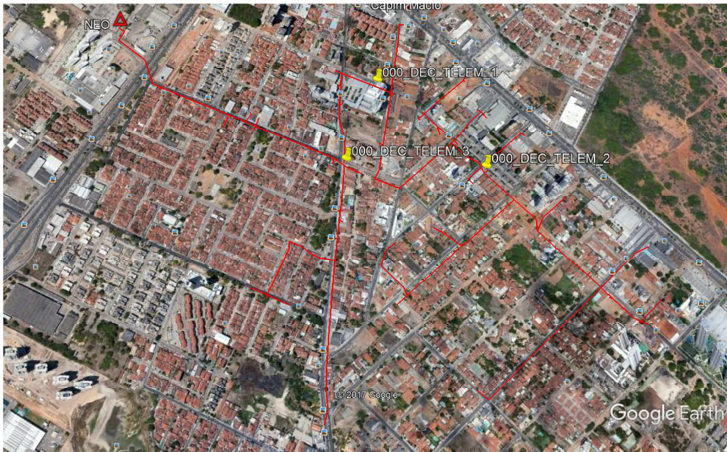
Figura 26 – Traçado do ALIM 2 em vermelho juntamente com o posicionamento dos novos telecomandados sugeridos destacados pelo símbolo marcador amarelo. (Fonte: Google Earth, 2017).
