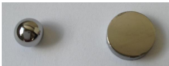
Figura 9 – Esfera e disco plano do ensaio HFRR
