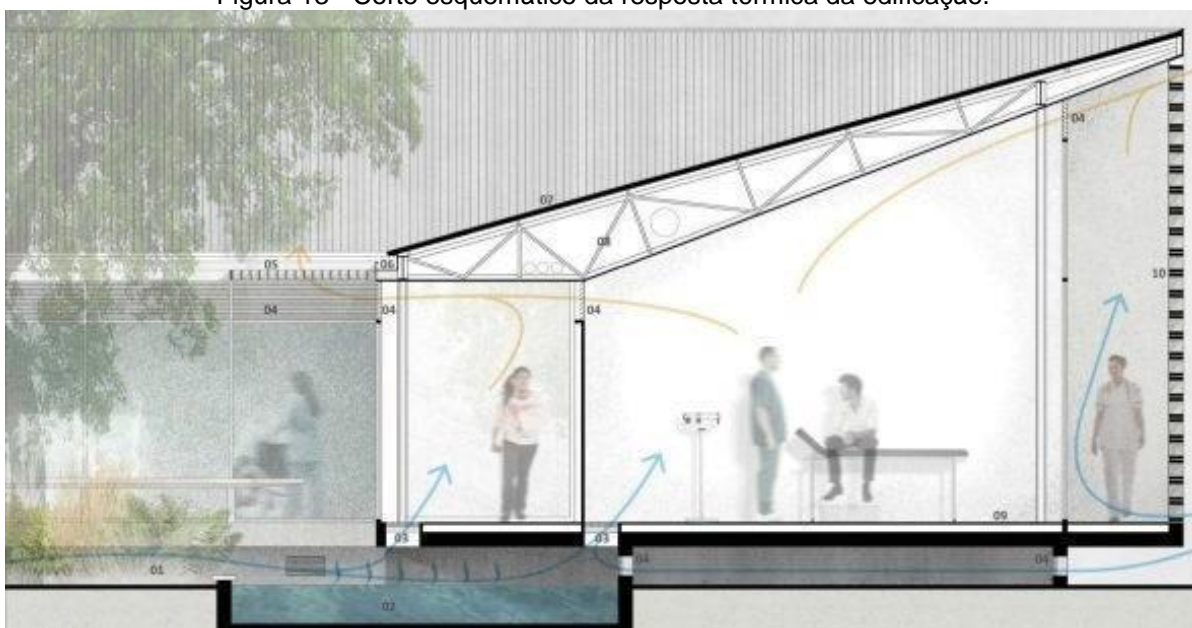
Figura 13 - Corte esquemático da resposta térmica da edificação.
