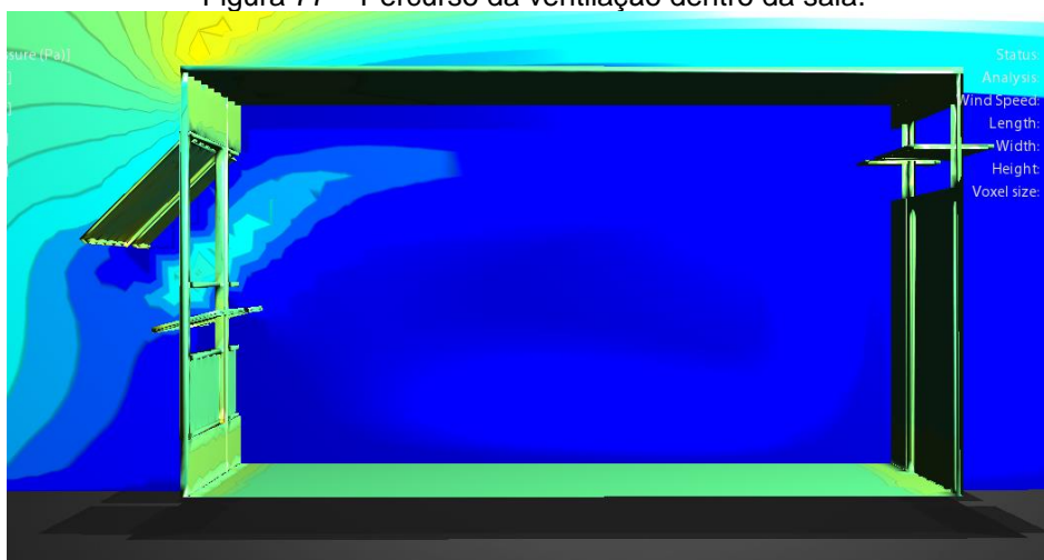
Figura 77 – Percurso da ventilação dentro da sala.
