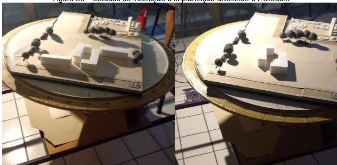
Figura 56 – Estudos de insolação e implantação utilizando o Heliodon.
