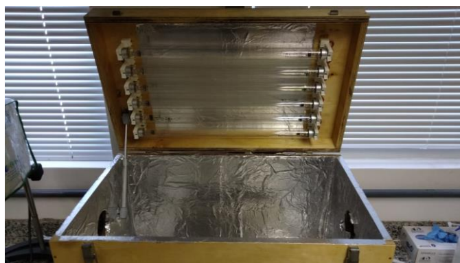
Figura 6: Foto reator com 6 lâmpadas UVC utilizado na fotocatalise.
