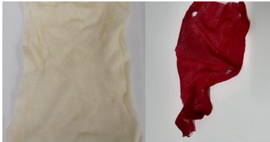
Figura 28 - Tecido de soja antes (imagem a) e após o tingimento (imagem b) para a amostra P4.
