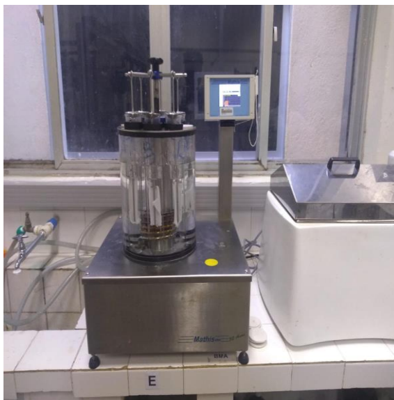
Figura 19 - Imagem da máquina de tingimento (BMA, Mathis LTE), usada na lavagem, alvejamento e tingimento da malha de fibra de soja utilizada neste trabalho.
