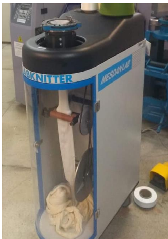
Figura 18 – Imagem do tear de malharia MESDANLAB utilizado no preparo do tecido de fibra de soja.
