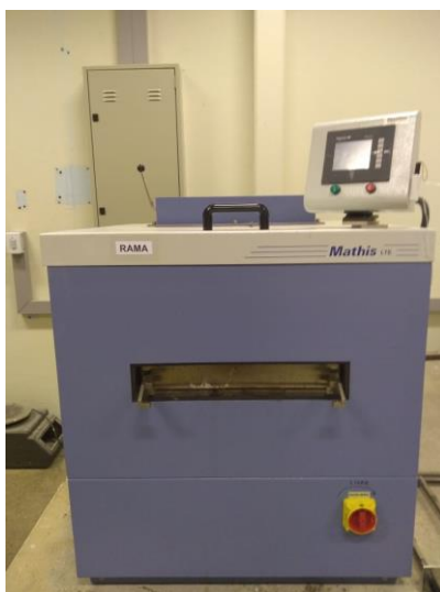
Figura 20 – Imagem da câmara de secagem RAMA (Mathis, modelo LTE), usada na secagem da malha de fibra de soja.
