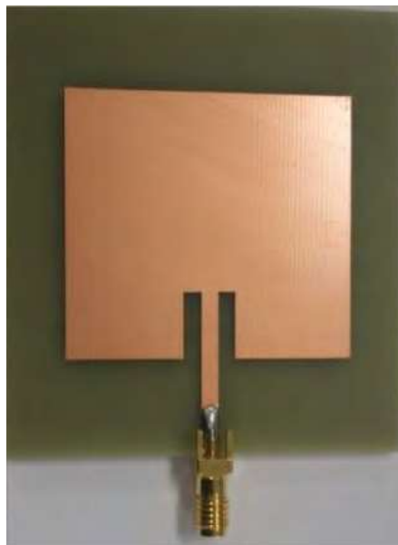
Figura 2. 5. Antena de Microfita com Patch Retangular. Fonte: (Autor 2020).
