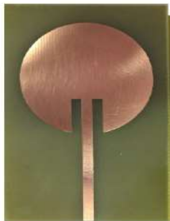
Figura 2. 13. Exemplo de antena de microfita com inset feed . Fonte: [19]
