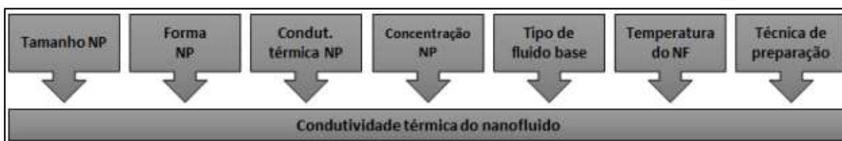
Figura 8 – Parâmetros que afetam a condutividade térmica de nanofluidos
