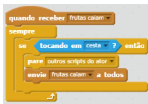
Figura 6. Evento que deveria ser responsável por adicionar uma fruta à cesta do personagem do jogador, mas apresenta bug (lacuna) a ser corrigido.
