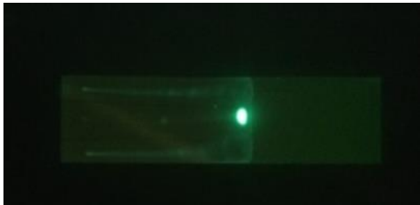
j) CCD de amostra de ração para pássaros (alto custo) sob UV após pulverização com ácido sulfúrico 25% - período úmido. Fonte: compilação do autor.
