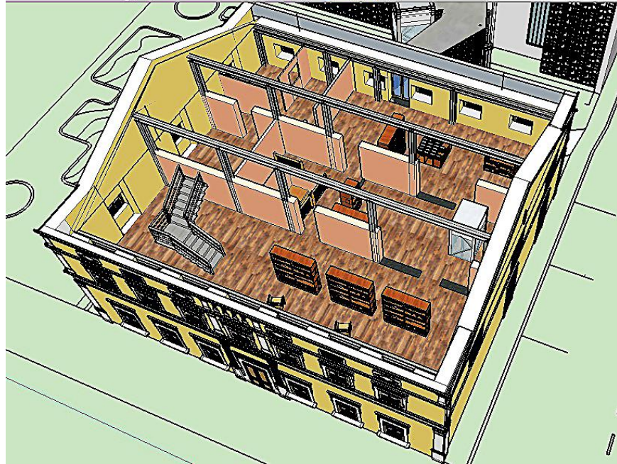
Figura 74: A estrutura metálica no sobrado, segundo pavimento
