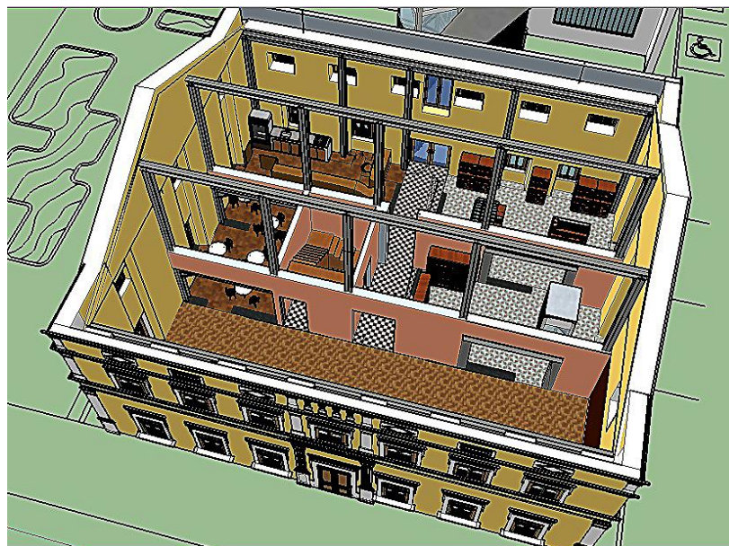
Figura 73: A estrutura metálica no sobrado, pavimento térreo
