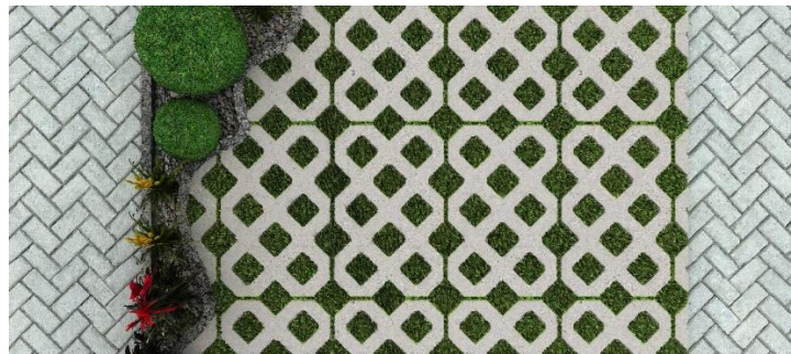
Figura 62 - Cobograma no centro e piso intertravado nas laterais
