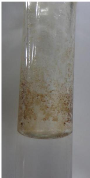
Figura 12: óleo essencial do TCC aderido à parede do Clevenger. Fonte: Autora.
