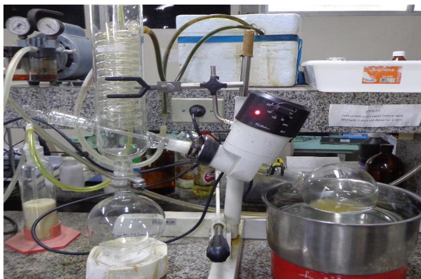
Figura 11: destilação no rotaevaporador da fase óleo e emulsão. Fonte: Autora.
