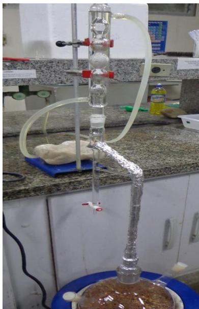
Figura 9: hidrodestilação pelo aparelho de Clevenger. Fonte: Autora.
