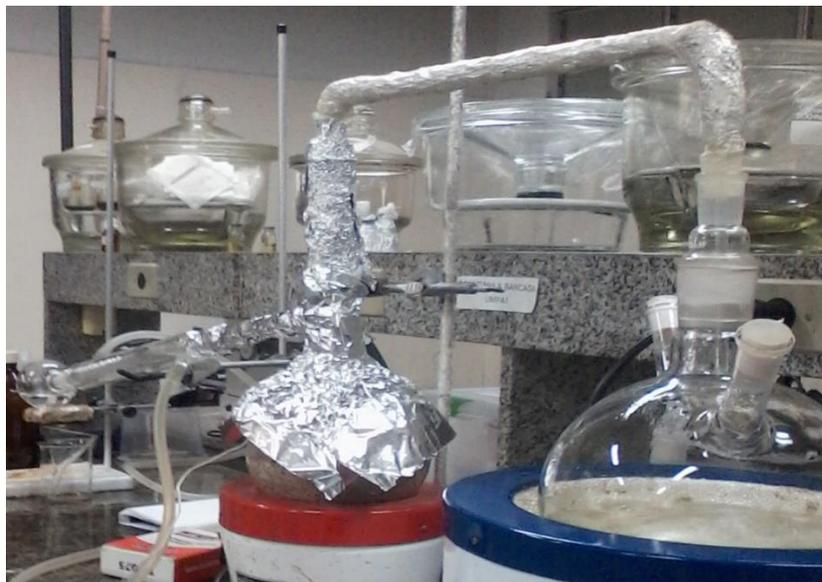
Figura 10: extração por destilação por arraste de vapor. Fonte: Autora.
