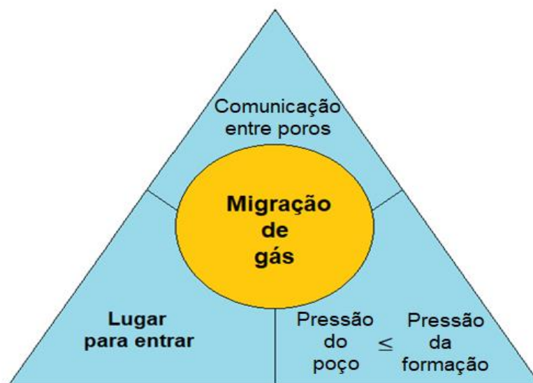
Figura 3 - Principais causas da migração de gás anular.
