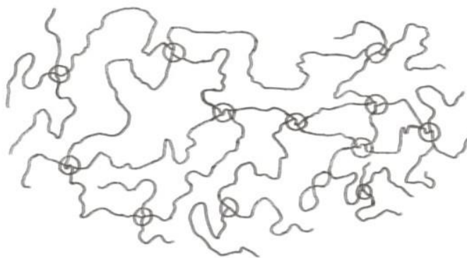
Figura 13 - Efeito provocado pelo entrelaçamento do polímero.
