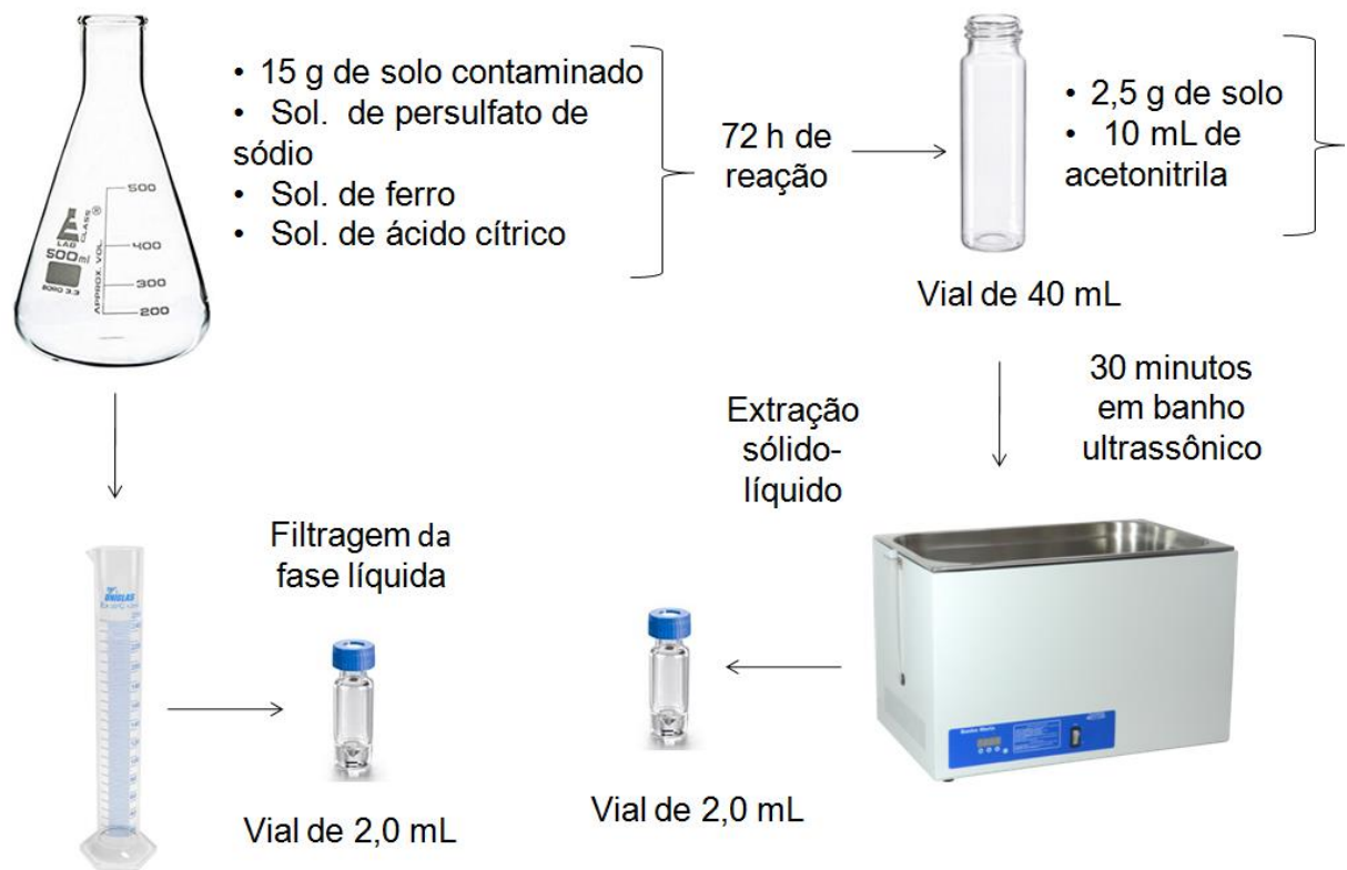
Figura 4 - Esquema de metodologia de ensaios em batelada e separação de fase líquida e extração sólido-líquido para análise.
