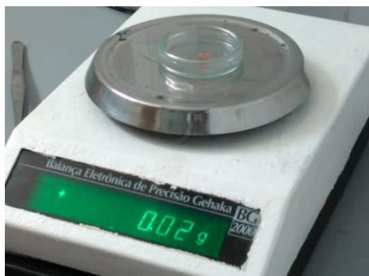
Figura 6. Cortes teciduais padronizados em balança de precisão com peso de 0,02g. Fonte: Arquivo pessoal.
