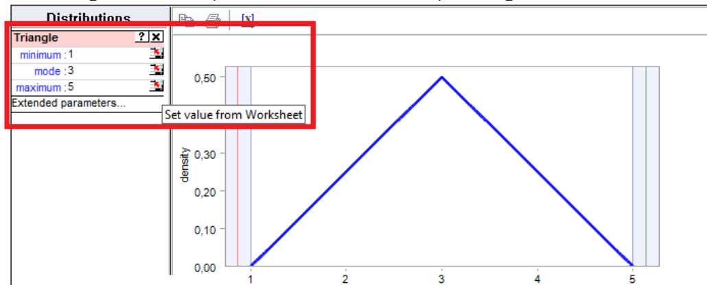
Figura 2.15 - Inserção de Parâmetros da Distribuição Triangular no Simulador
