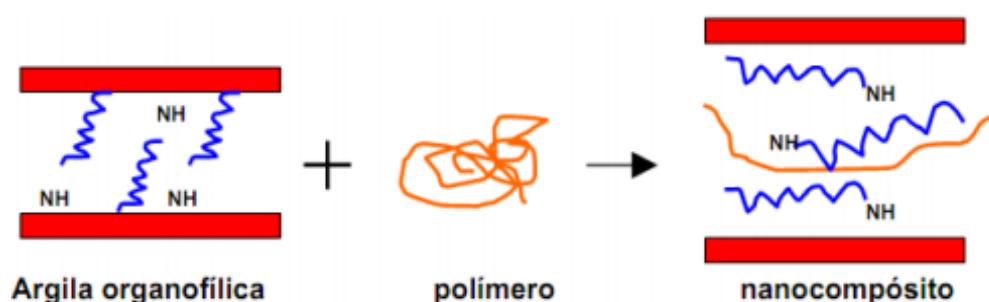
Figura 13 - Esquema de obtenção de nanocompósito através do processo de intercalação por fusão.
