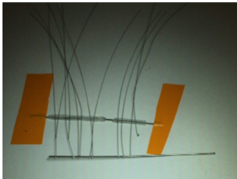
Figura 4.14 - Contatos são encurvados. Fotografia da etapa de fabricação do eletrodo em que os contatos são encurvados com auxílio de um segundo mandril.
