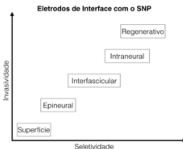
Figura 3.7 - Eletrodos de Interface com o SNP. Os diferentes tipos de eletrodos aplicados a interfaces com nervos do SNP com classificação de acordo com a seletividade e invasividade. Adaptado de NAVARRO, 2005.
