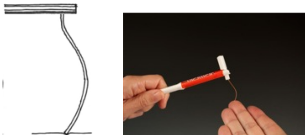
Figura 3.12 - Filamento de von Frey. À esquerda: Desenho esquemático do comportamento de um filamento de nylon quando solicitado longitudinalmente em contato com uma superfície (BOVE, 2006). À direita: Exemplo de filamento de von Frey, que é utilizado clinicamente em neurologia e em pesquisa (DanMic Global ® ).
