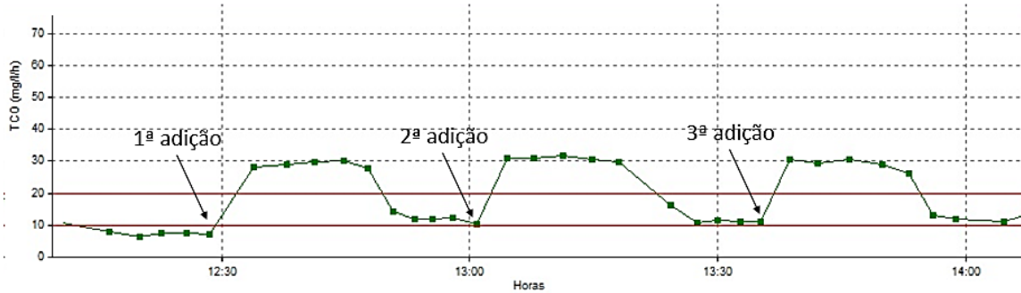
Figura 6: Amostra 1-Respirograma gerado por três adições de 38,3mgDQO/L.
